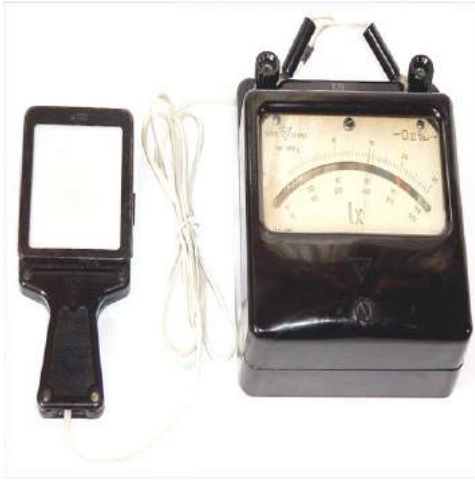
Şəkil 9. Ю-16 və “ТКА-ЛЮКС” tipli rəqəmli lüksmetr.
