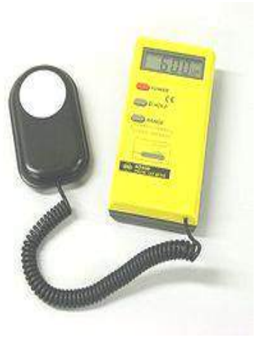
Şəkil 9. Ю-16 və “ТКА-ЛЮКС” tipli rəqəmli lüksmetr.
